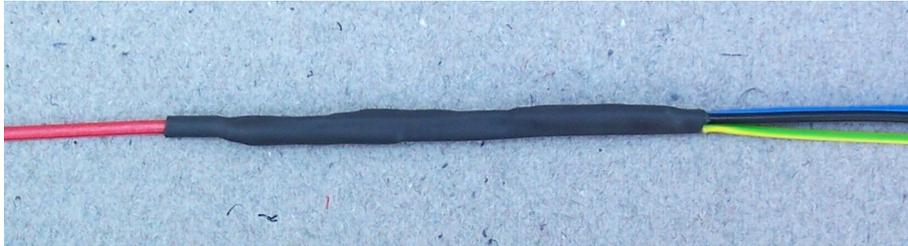
Den großen Schrumpfschlauch überziehen und verschrumpfen, dabei darauf achten das die drei einzelnen Innenleiter gerade einliegen und das mindestens 1cm des Heizkabel-Außenmantels vom Schrumpfschlauch erfasst wird
