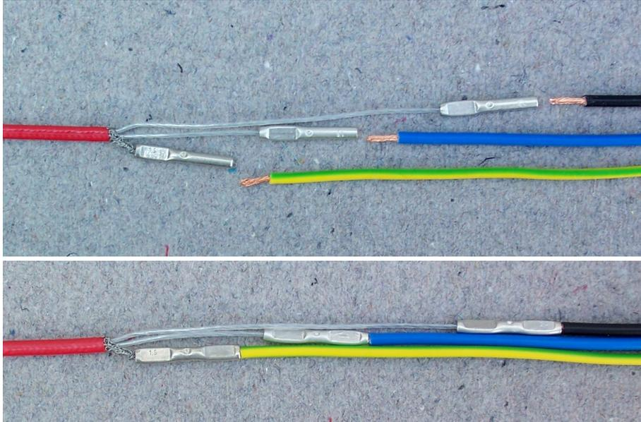
Überbrückungskabel ca. 1cm abisolieren, in die Quetschhülsen stecken und flach verpressen, dabei ist darauf zu achten, dass das Schutzgeflecht mit dem gelb/grünen Draht verbunden wird.
