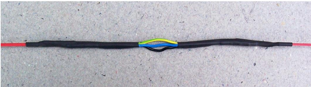
Den großen Schrumpfschlauch über die Reparaturstelle ziehen, darauf achten, das wieder ca. 1cm des Heizkabel-Außenmantels abgedeckt wird und verschrumpfen.
