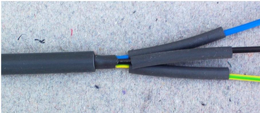
Schrumpfschläuche in umgekehrter Reihenfolge überziehen. Wenn die erste Schrumpfstelle erkaltet ist, läßt sich der große Schlauch komplett überziehen und die drei kleinen lassen sich ganz nach hinten durchziehen. So braucht man am wenigsten Platz.
