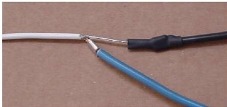
Die Verbindungsstelle zwischen Heizlitze und Überbrückung ist hier mit dem kleinen Schrumpfschlauch überzogen und mittels Heißluftfön verschrumpft. Drücken sie kurz nach dem fönen die Schrumpfschlauchenden fest zusammen, damit der verflüssigte Kleber richtig abschließt. Weiterhin ist hier zu erkennen, wie das Schutzgeflecht zu verquetschen ist.
