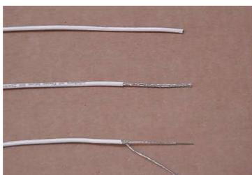
Unser Heizkabel ist ein sogenanntes Koaxialkabel, der Aufbau ist vergleichbar mit dem eines Antennenkabels. In der Mitte befindet sich die stromführende Heizlitze, die mit einer Teflonummantelung isoliert ist. Dieser Teflonmantel ist mit einem, stromlosen Schutzgeflecht umwoben, welches wiederum von einer PVC-Hülle isoliert ist.
