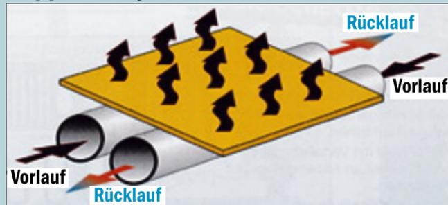
Beim gegenläufigen Doppelrohrsystem von Jollytherm steht an jeder Stelle der zu beheizenden Fläche die gleiche Heizkraft zur Verfügung. Dies verdankt man den zwei Rohren: An den Punkten, wo in einem Rohr das Wasser abzukühlen beginnt, ist das Wasser im Rohr daneben noch heiß. So ist der ganze Boden immer gleichmäßig warm und behaglich.
