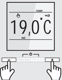
2 Der voreingestellte Bildschirmschoner ist "Temperatur". Drücken und halten Sie die **MODE/OK** Taste für 2 sec. Die Anzeige wechselt zu „aktuelle Zeit“
