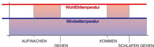
Im Comfort- Modus wird die von Ihnen gewünschte Wohlfühltemperatur gehalten. Im Economy- Modus wird zur Energieeinsparung die Temperatur auf die von Ihnen eingestellte Mindesttemperatur abgesenkt und diese gehalten.
